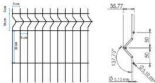
De acordo com o projeto padrão (para terreno de 45 x 35 m), haverá fechamento com gradil de 1,58m de altura, com pilaretes metálicos e tela de aço galvanizado de tamanho fixo, instalado na parte frontal do lote, acima de mureta de alvenaria de 0,62m de altura. Caso o terreno disponível seja maior, o ente requerente poderá utilizar-se do padrão de fechamento aqui descrito para a instalação em todo o seu terreno, ficando o custeio do excedente a cargo do requerente.
